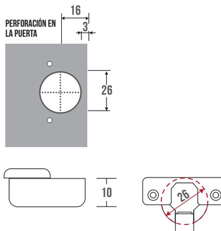
Profundidad de la perforación donde se coloca la cazoleta 10mm.
