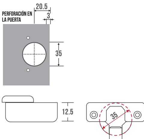
Profundidad de la perforación donde se coloca la cazoleta 12.5mm.
